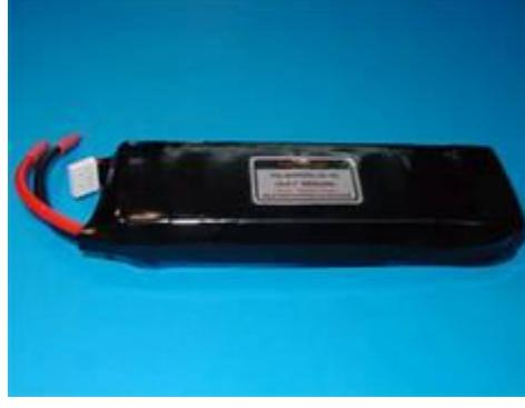
המנוע עדין שוקל 186 גר' וסתוללה החדשה שוקלת עוד 264 גר', יחד משקל המערכת כ- 450 גר'. ניגש לחישוב משקל הטיסנה ועומס הכנף:
